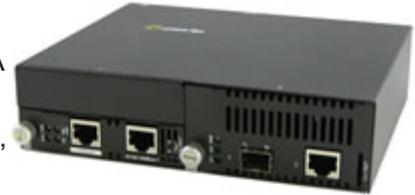
Perle **SMI-10GRT-SFP Managed Medienkonverter verbinden auf transparente Weise** 10/100/1000/2.5G/10GBase-T Ethernet Links über Multimode oder Single Mode LWL. Jeder Medienkonverter hat einen RJ45 Port und einen leeren Slot für ein SFP oder SFP+ Modul.
